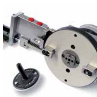
Поворотний стіл для виробництва двокomпонентних деталей
